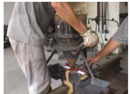
El crisol desechable no permite la visualización de su posicionamiento. Para ello, la abrazadera del tubo de la prensa universal posee un batiente.
