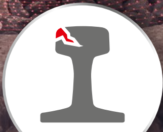
FISSURAS EM BOLETOS
